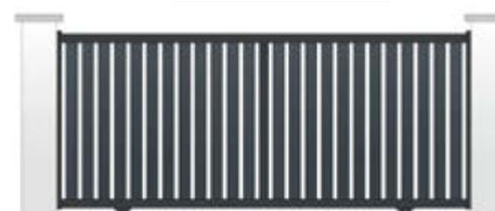
Portail réalisé avec des profils de sections : traverse basse de 70x40mm, traverse haute de 70x40mm, montants de 70x50mm côté gonds et au centre. Barreaudage en partie supérieure avec des lames ajourées (ajourage de ± 60mm). Soubassement avec des lames horizontales et jointives de 100x20mm ou 200x20mm\*.
