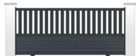
Portail réalisé avec des profils de sections : traverse basse, intermédiaire et haute de 70x40mm, montants latéraux et centraux de 70x50mm. Barreaudage central réalisé avec des lames de 100x20mm ou 200x20mm\* disposées horizontalement et espacées. Positionnement du barreaudage suivant le modèle. Remplissage complémentaires réalisés avec des lames jointives.
