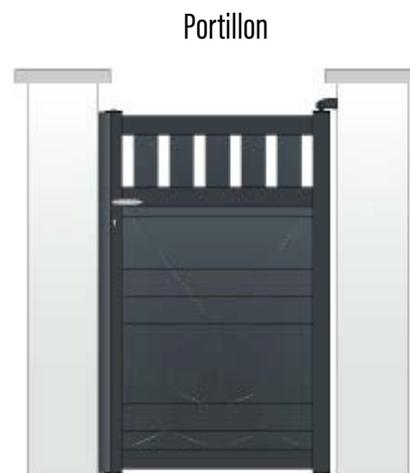
Portail réalisé grâce à un remplissage en partie haute avec une tôle aluminium 2mm assortie d'un décor par découpe laser. Un soubassement avec des lames de 100x20mm disposées horizontalement et jointives. Option de remplissage par lames de 200x20mm possible en plus-value; ou, avec de la lame de 130x20mm disposée horizontalement uniquement, façon brise vue (sans plus-value).
