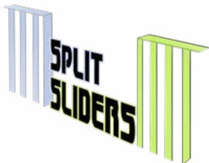
Les portails coulissants à double refoulement **SPLIT SLIDERS** fonctionnent avec un espace de dégagement réduit de moitié (réparti à gauche et à droite) grâce au dédoublement des vantaux qui refoulent symétriquement.
