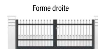
Portail réalisé avec des profils de sections : traverse basse de 160x50mm, traverse intermédiaire de 80x50mm, traverse haute de 50x50mm, montants de 80x60mm. Remplissage de la partie supérieure avec des barreaux de 20x20mm disposés verticalement, espacés et traversants. Remplissage de la partie basse par une tôle d'épaisseur 2mm. Finition des barreaux au choix en page 57.
