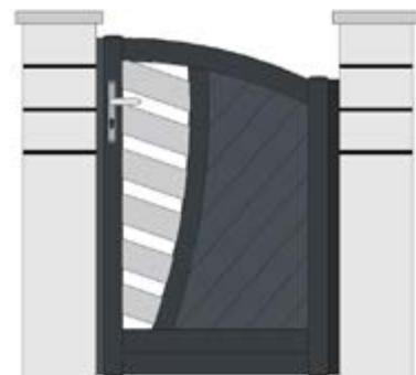
Portail réalisé avec des profils de sections : traverse basse de 160x50mm, traverse haute de 80x50mm, montants de 80x60mm. Montants centraux inclinés de 80x50mm. Remplissage au centre du vantail avec des lames de 100x20mm espacées et inclinées. Remplissage de part et d'autre du barreaudage central avec de la tôle laquée de 2mm.
