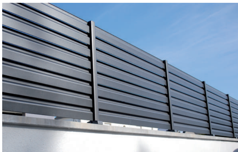
Clôture réalisée avec des lames hélices de 110x20mm disposées horizontalement avec un chevauchement de 5mm.
