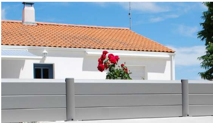
Clôture en Aluminium réalisée avec empilement des planches de forme trapèze et de section 130x20mm, disposées horizontalement. Poteaux universels de 80x60mm.
