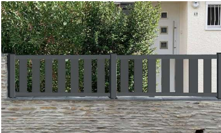
Traverses horizontales de 70x40mm et barrodage verticale de 100x20mm Poteaux de 70x70mm. En option lames de 130x20mm ou 200x20mm.
